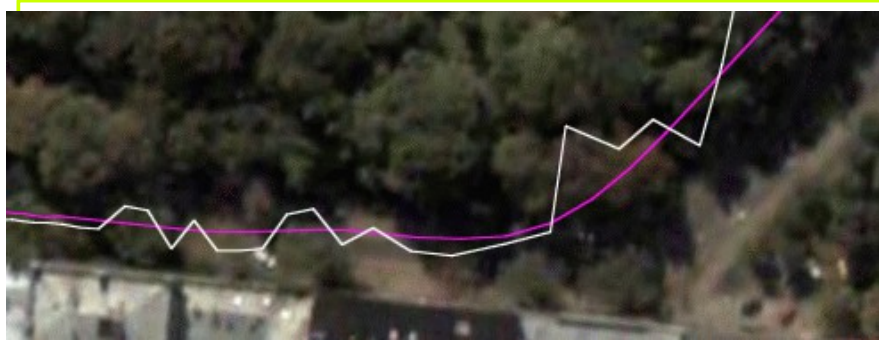
linia biała: standardowy odbiornik RTK; linia fioletowa: SPAN
